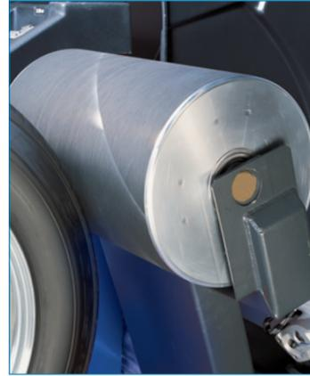
Grâce au rouleau qui exerce une pression de 635 kg sur le pneumatique en rotation, un test routier est simulé.
