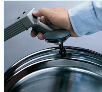
Le voile latéral et le voile radial peuvent aussi être mesurés sur chaque siège de la jante.
