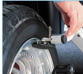
Le voile latéral et le voile radial (faux-ronde) sont mesurés sans démonter le pneumatique pour savoir s'il est en cause.
