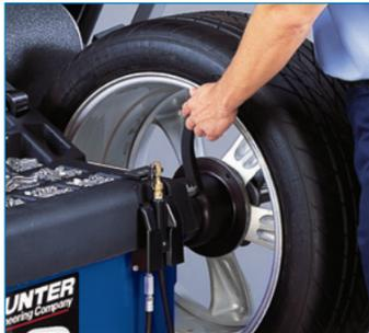
Grâce aux 2 bras électroniques, on mesure le voile latéral et le voile radial (faux-ronde) pour déterminer la part de problèmes à imputer au pneumatique et à la jante.
